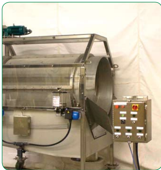
Drumscreen Monster obuhvata i automatski regulator. JWCI nudi opcioni sistem automatskog podmazivanja i pogone sa varijabilnim frekvencijama.
