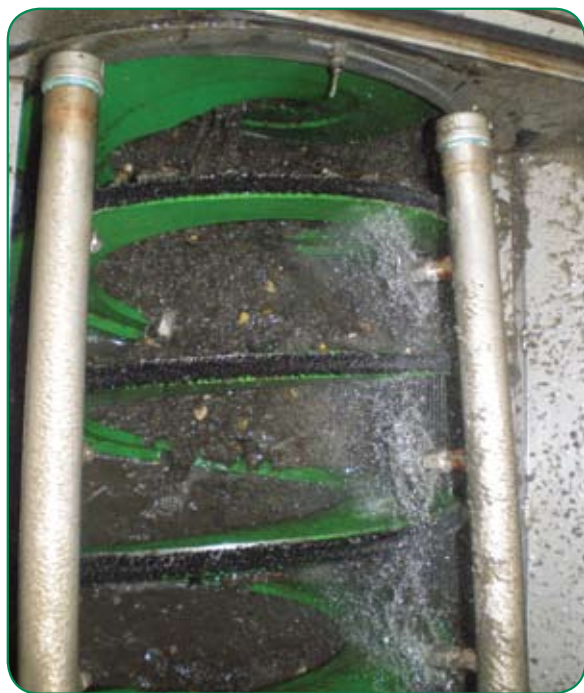
Krupan plan filtera na svrdlu Honey Monster i sistema za pranje prskanjem. Neorganske čvrste materije se zadržavaju, čiste i uklanjaju.
